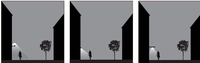
Exempel på god trygghetsskapande fasad- och ingångsbelysning
